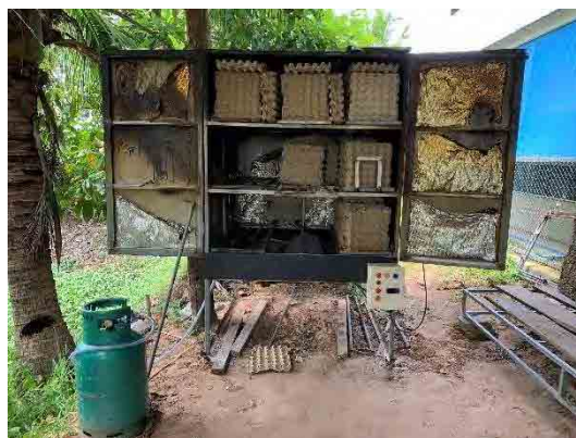
図 4-10 卵カートン用のガス式乾燥炉
