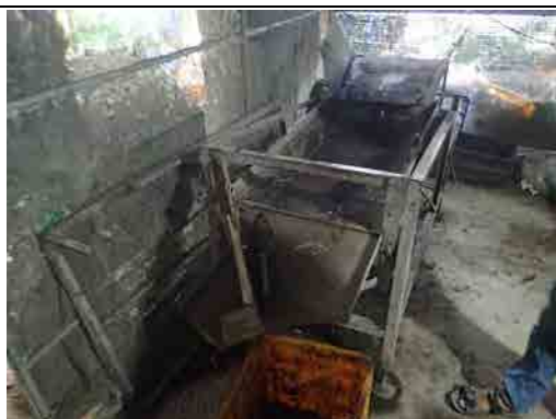
幼虫を分離するための自作のふるい機
