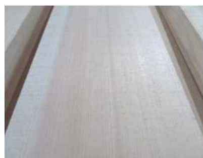
写真4 年輪が細かく節の無い吉野材
