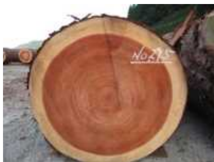
写真4 年輪が細かく節の無い吉野材
