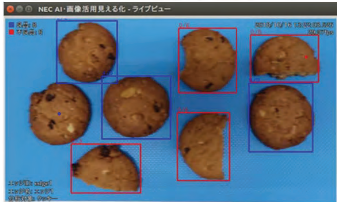
AIが画像から良品・不良品を自動で判別する (クッキーの製造ライン)
