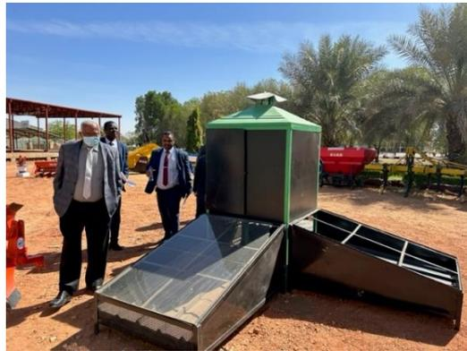
スーダン製ソーラー式乾燥機（熱源は太陽光のみで中央部の天井にある換気扇で排気）
