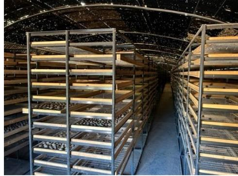
スーダン製ビニールハウス式乾燥機（熱源は太陽光のみで側面にある換気扇で排気）
