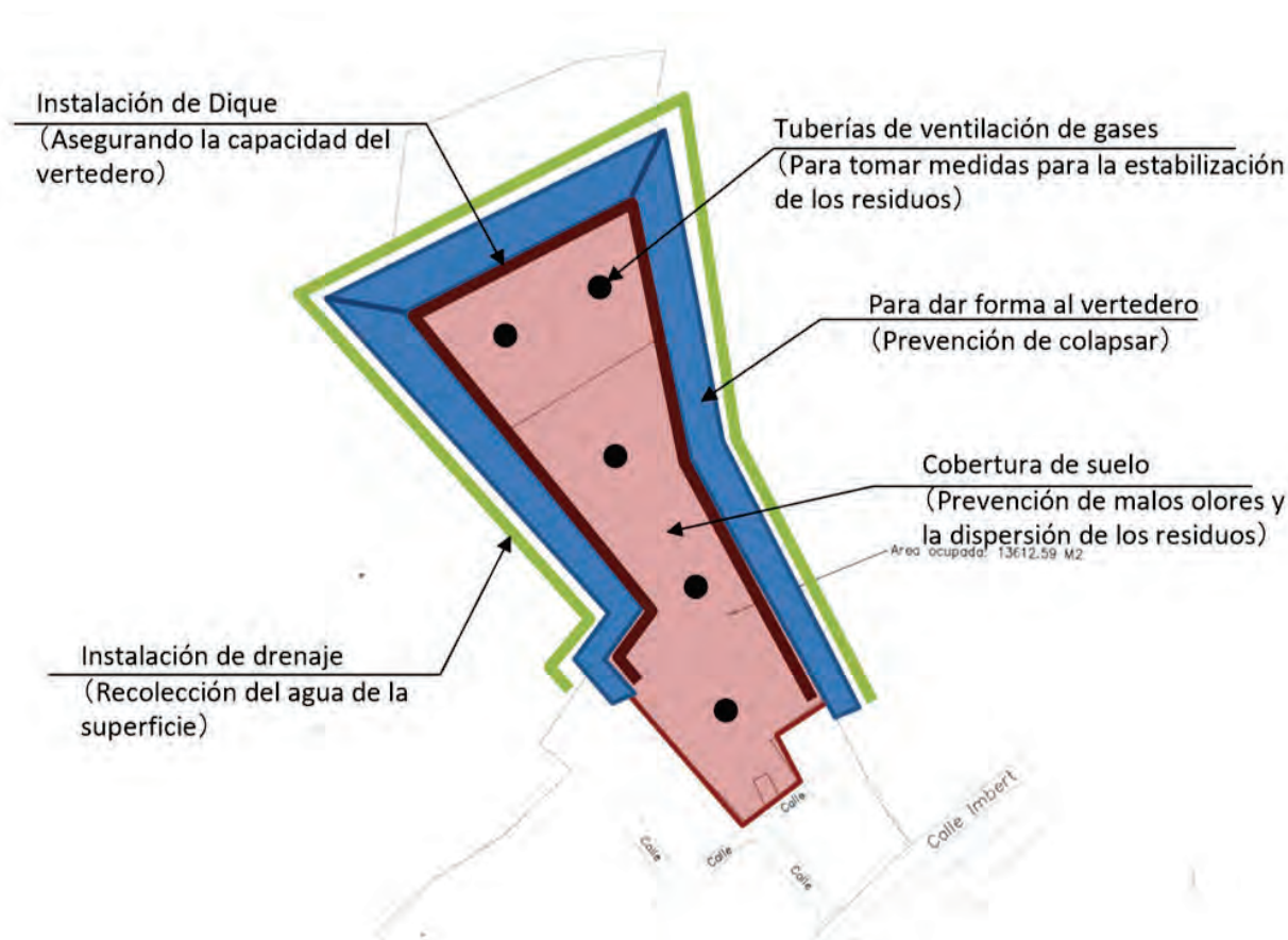
Figura 26: Esquema conceptual del cierre para la preparación del proyecto
