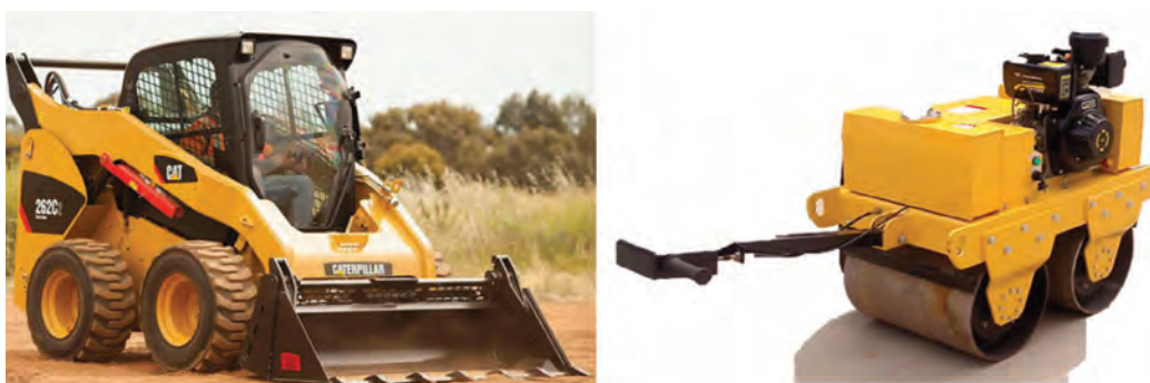
Figura 3. Equipos livianos para carga y compactación de material respectivamente.
