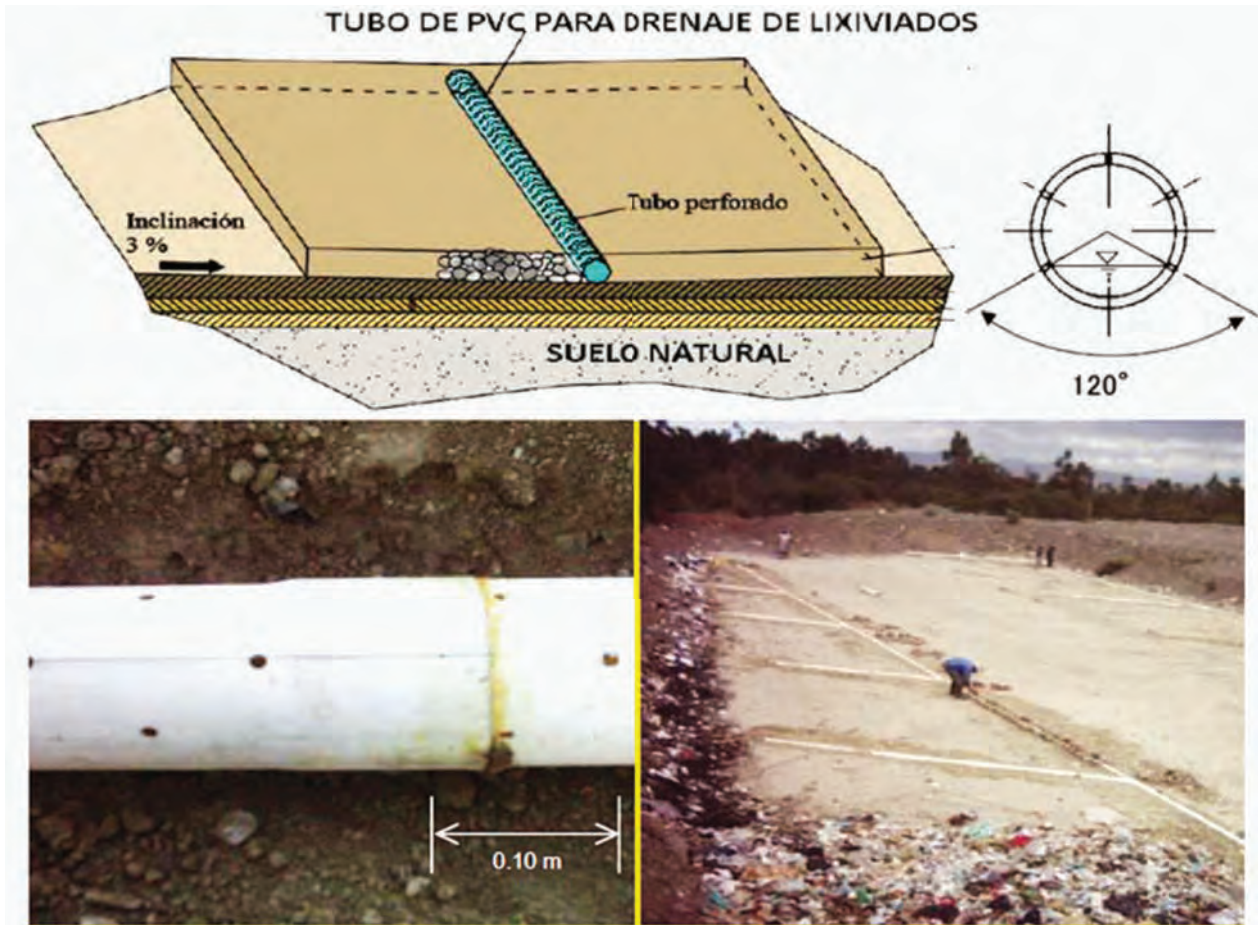
Figura 32: Tubería para drenaje de lixiviados en la celda
