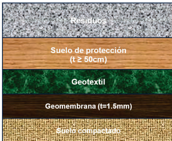
Figura 17. Esquema del Sistema de impermeabilización requerido en cada celda
