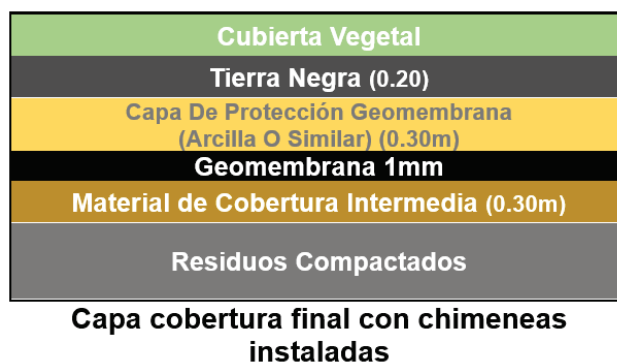
Figura 16. Esquema de la cobertura final
