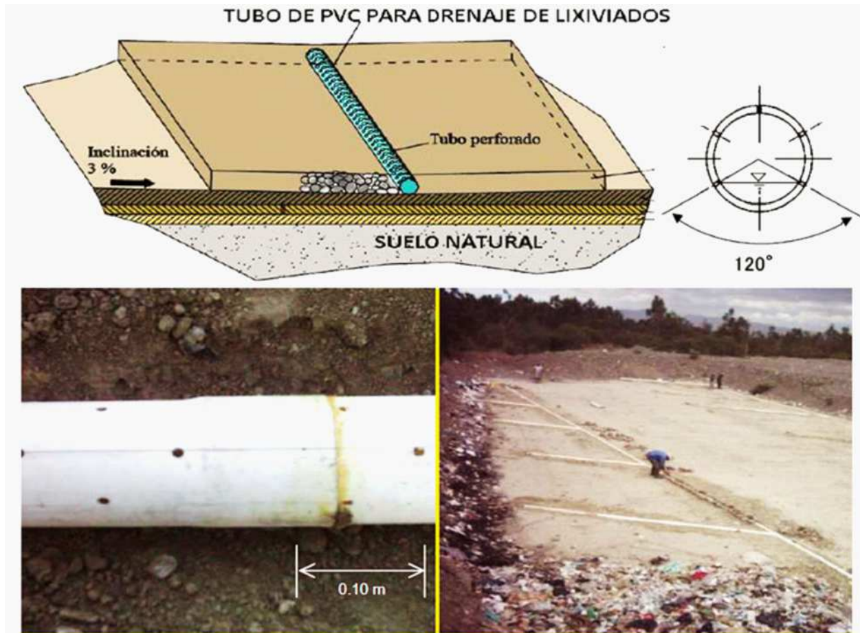
Figura 2-22 Tuberías de drenaje de lixiviados en la celda
