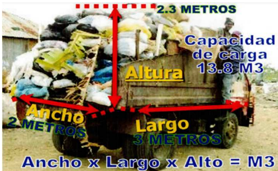
図 2-79 廃棄物収集車両の廃棄物運搬容量算定（例）
