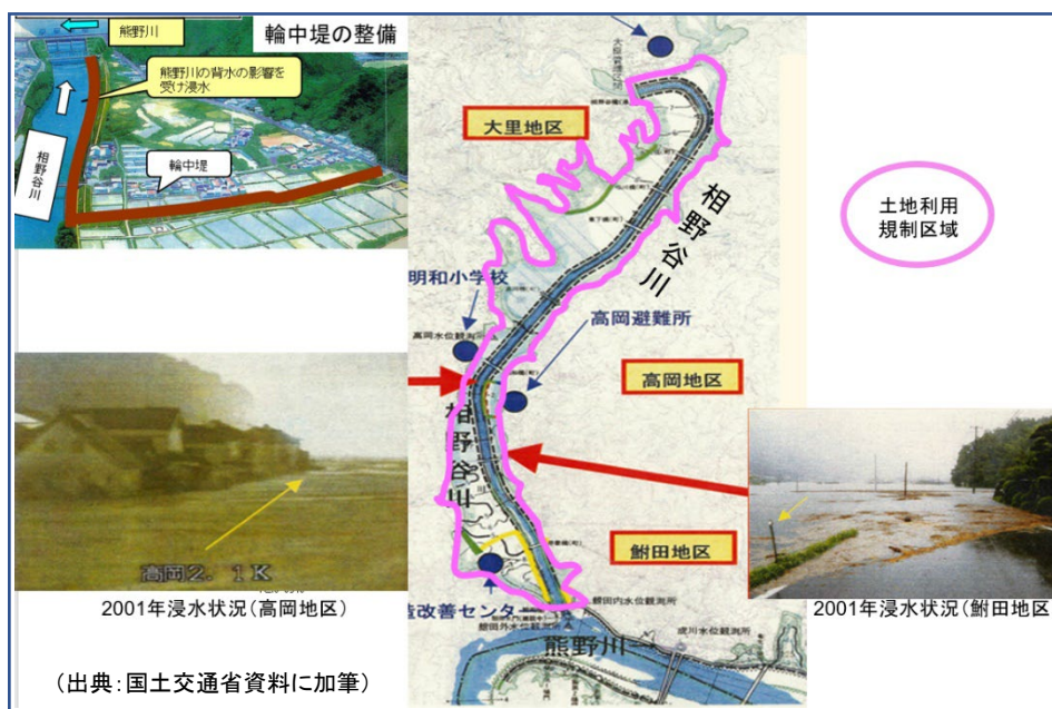
図 3.17 集落を守る輪中堤と浸水区域の土地利用規制（三重県：相野谷川）
