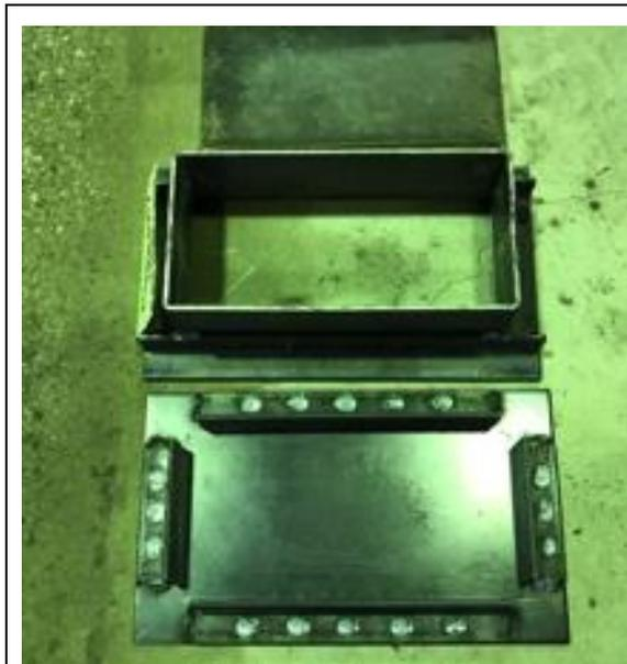
写真 2 特殊表面加工技術が施されたレンガ金型枠
