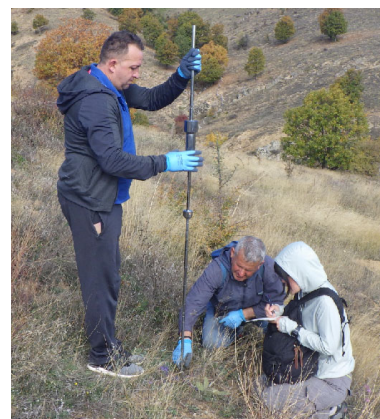
土層貫入計を使った土層硬度の測定
