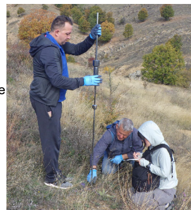
Мерење тврдост на почвата
