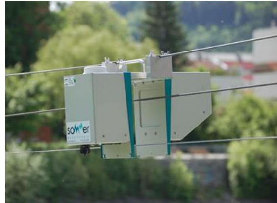
ADCP (M9) の観測方法と流速 (カラーコンター) のイメージ 電波流速計 (RP30) のイメージ
