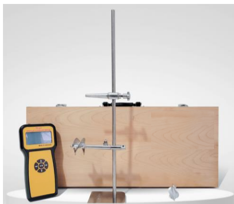
図1 プロペラ式流速計の事例
