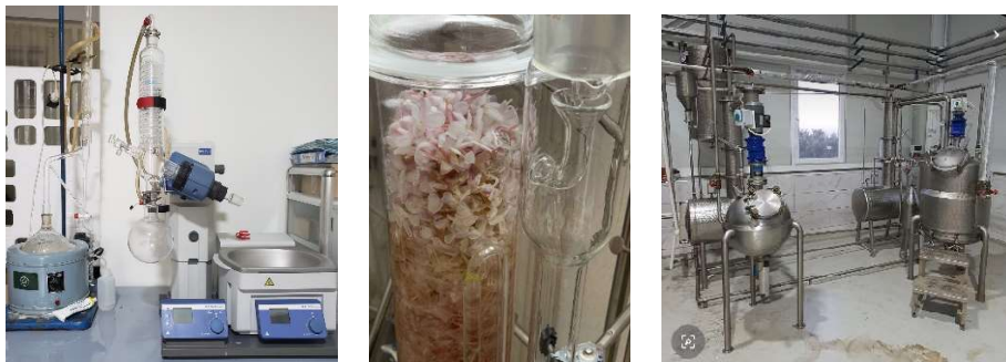
写真2. 2L ソックスレー抽出器（左の2つ）と 100L 水蒸気蒸留装置（右）
