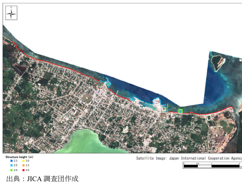
図 3.6.2 嵩上げ護岸の設定 (M.S.L.+3.0m に嵩上げ)
