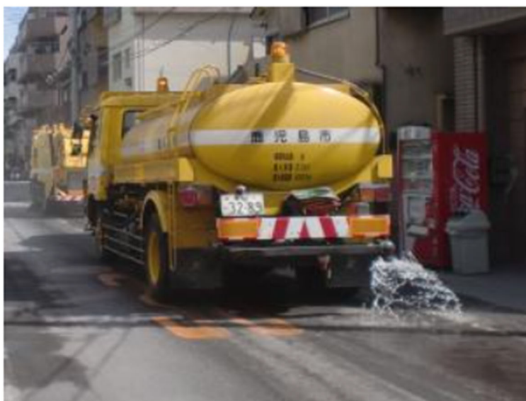
図 3.3.8 散水車（火山灰が舞い上がるのを防ぐために散水）
