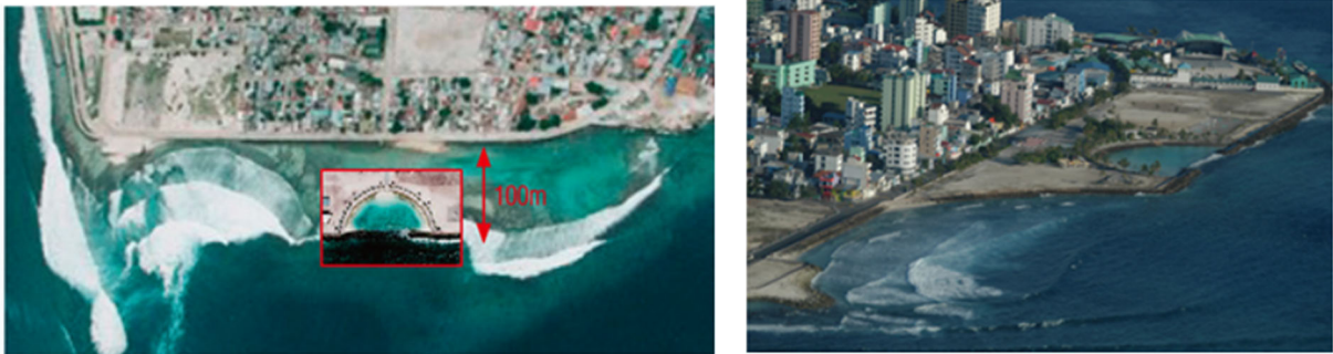
図 3.3.2 モルディブにおける津波対策の堤防設置前（左）と設置後（右）
