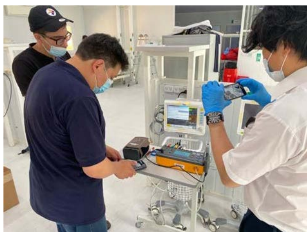
【図 3-63 ベッドサイドモニター校正中】
