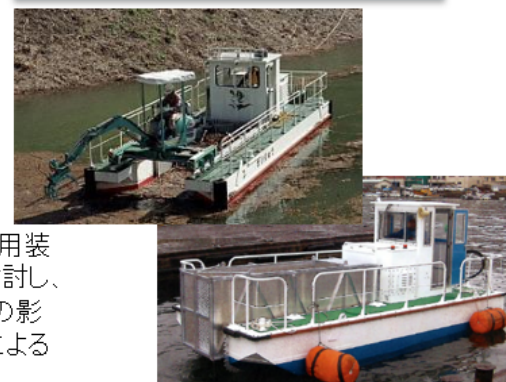
代表的な水面清掃船 (上)油圧ショベル式 (下)人力式(自然流入式)
