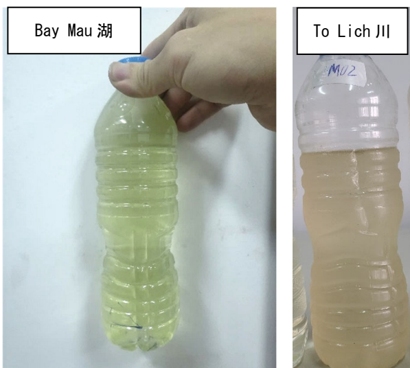
図 2-18 供試した湖水と河水の外観の違い
