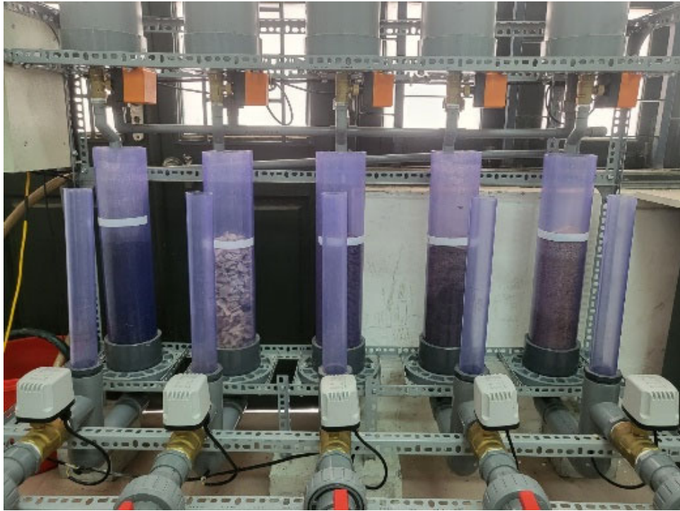
図 2-4 ろ材選定のための室内実験装置
