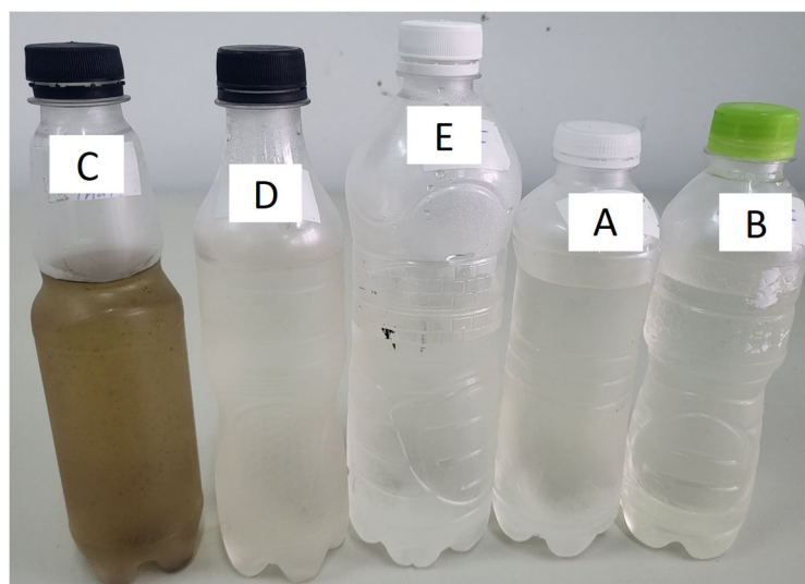
図 2-17 Bay Mau 湖の処理水の外観
