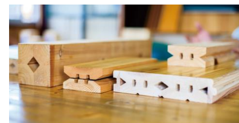
使いにくい部位を組み合わせて 歩留まりを向上させた合形集成材
