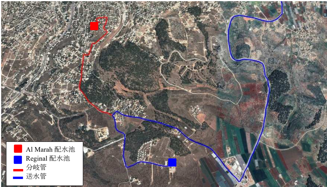
図 3-5 Al Marah 配水池への分岐管の路線
