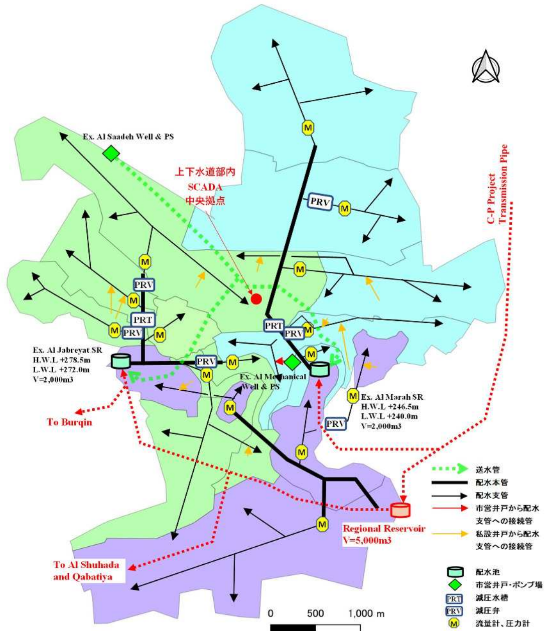
図 3-16 水道システム概要
