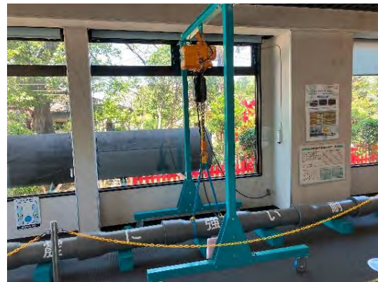
図 9-5 【クボタ社】HRDIPの曲げ実験装置
