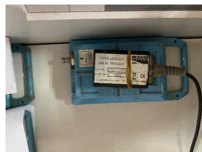
写真 3.4.1 圧力管理用データロガー
