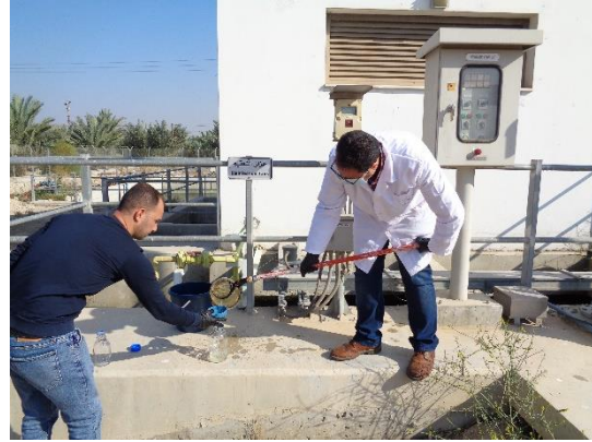
الصورة 2.2.4 أخذ عينات مياه معالجة
