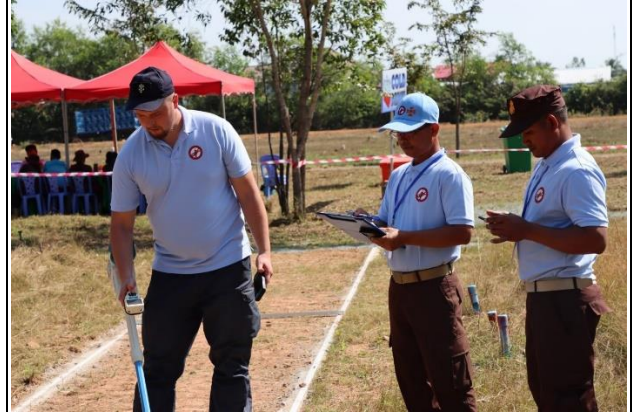
CMAC 指導の下、ウ国の研修参加者による ALIS を使った埋設物の探知訓練の様子 3（TIMA）
