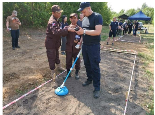
テストレーンでの評価試験 CMAC トレーナーが可視化した画像を確認
