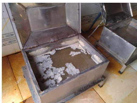
9. カニ原料ボイル釜
