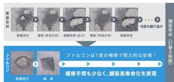
図 1 ファルコンによる恒久的な路面補修
