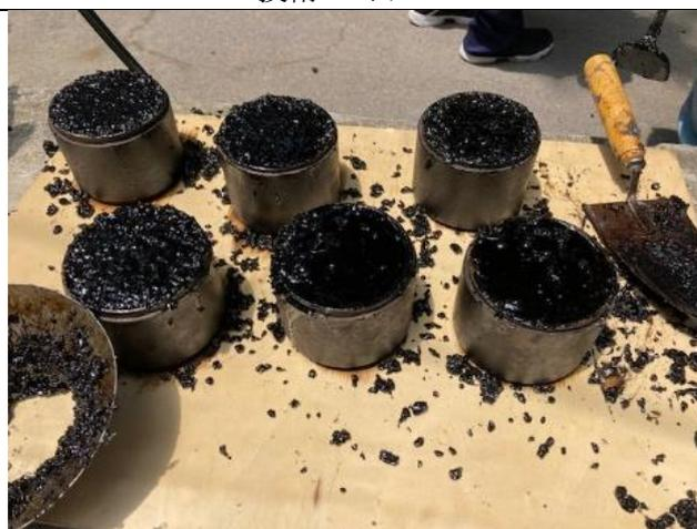
材料試験用の供試体
