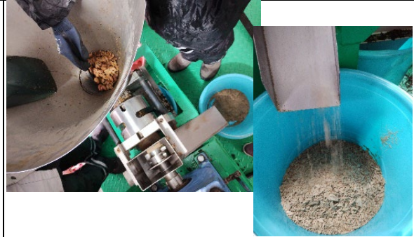
2022年12月16日: フェズ市内のソーセージ用腸管工場から入手した腸管廃棄物を油温減圧式乾燥システムで処理
