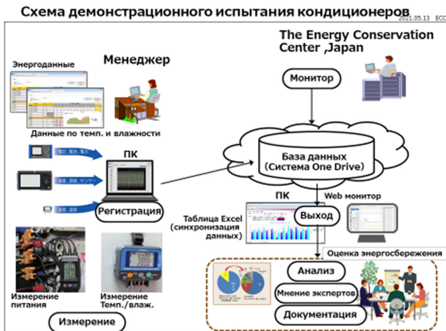
Рис. 30. Схема демонстрационного испытания кондиционеров
