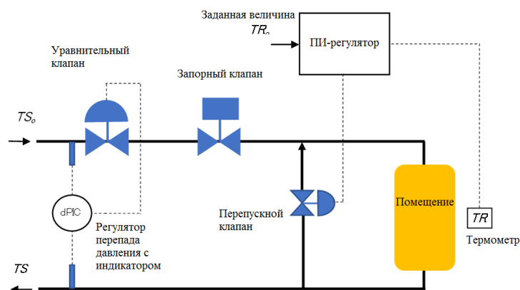
Рис. 28 Устройства автоматического регулирования для контроля количества подаваемой горячей воды в зависимости от заданной температуры в помещении
