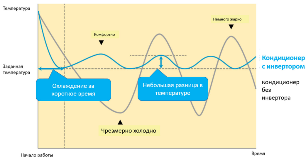
Рисунок 4-7 Сравнение динамики изменения температур для кондиционеров с инвертором и кондиционеров без инвертора
