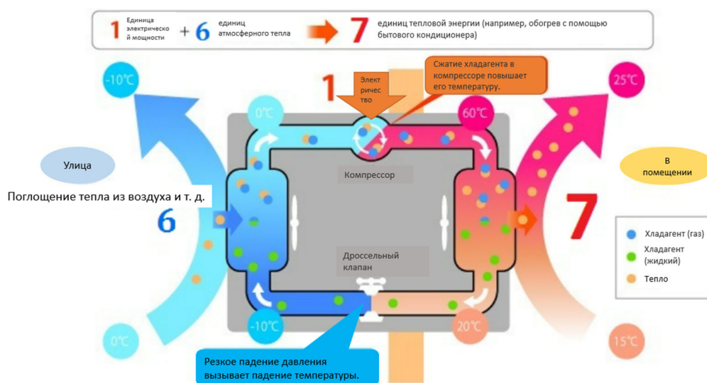
Рисунок 4-1 Устройство теплового насоса
