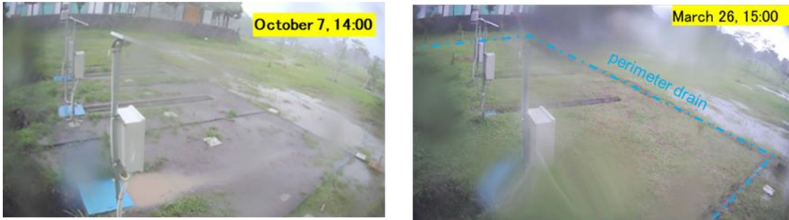
図 16 PP 試験区への雨水流入状況（左）と外周素掘り側溝による流入防止状況
