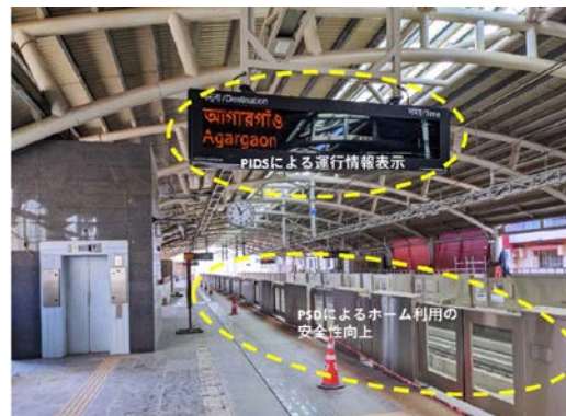
② 駅利用者の使いやすさの確保の例 運行情報表示、プラットフォームスクリーンドア
