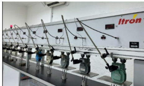
PGN 器差テスト装置 (メーターは他社製)
