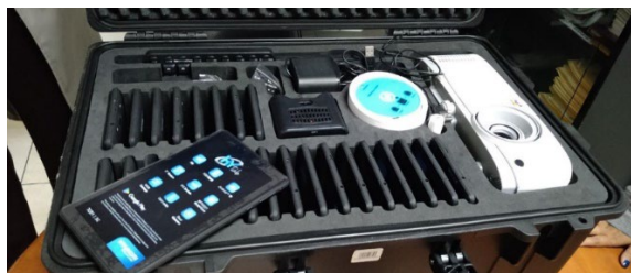
Kit de Tomi (proyector, altavoz, servidor de datos (dispositivo redondo), tableta (25 unidades))
