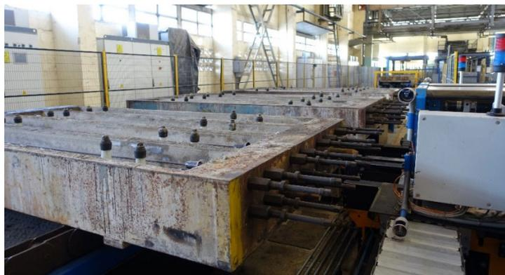
**Molde de travesa de concreto con barra de tensión antes del hormigonado**
