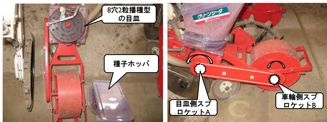
図 2-5 自然落下式の播種機（傾斜目皿式播種機：アグリテクノ矢崎, TDR）
