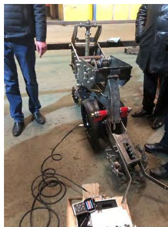
機体の重量測定
