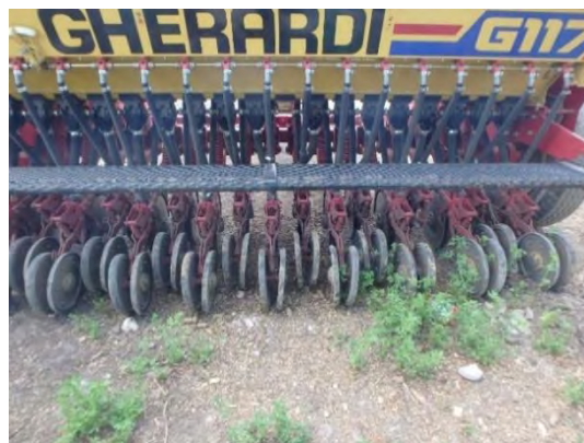
図 2-3 左：不耕起播種機（Moldagrotechnica, SK6）、右：Low-till planter（Gherardi, G117）
