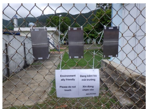
テストピース設置観察状況
