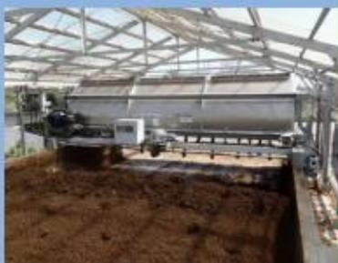
ロータリー式発酵攪拌装置
