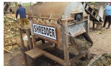
破砕機による有機物細分
