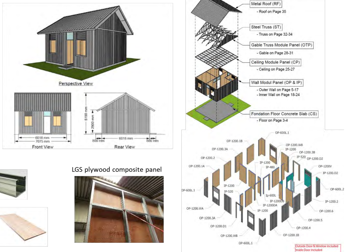
【Plywood steel composite method】
