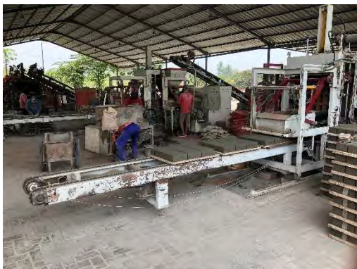
コンクリートブロック製造（機械式） 2019年10月31日
