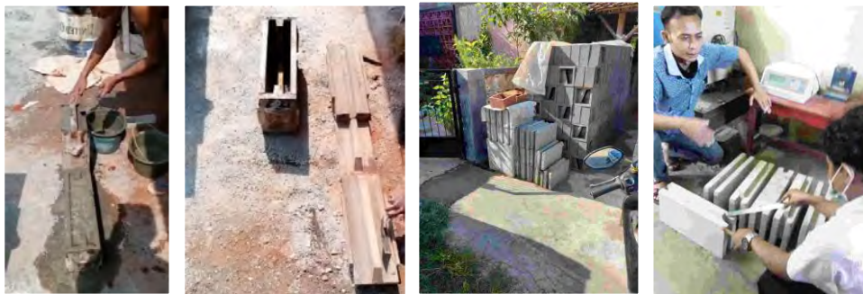
【写真 3-7 構造試験用試験体製造】
