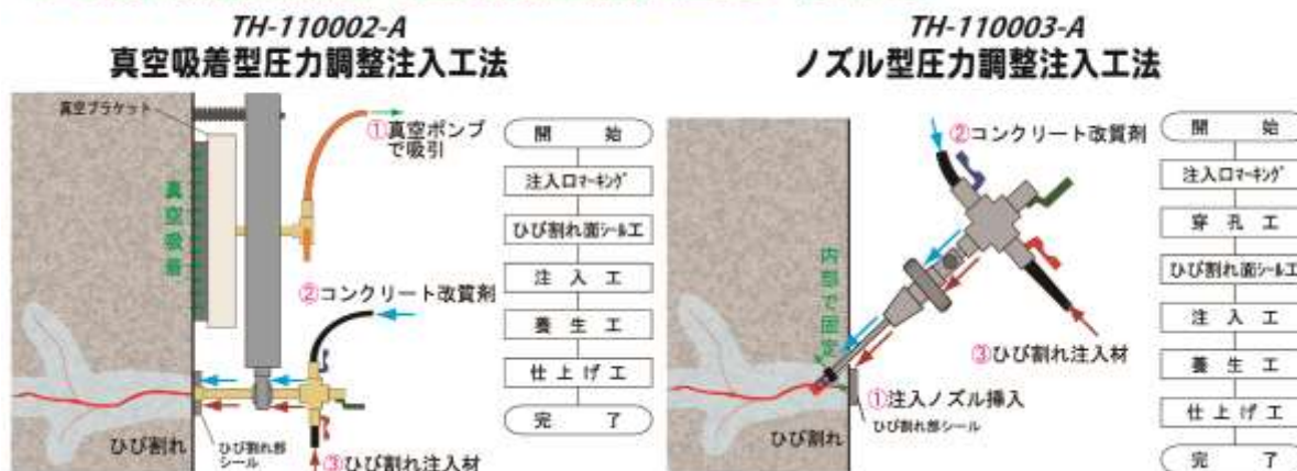
図2 圧力調整注入工法の注入機構
