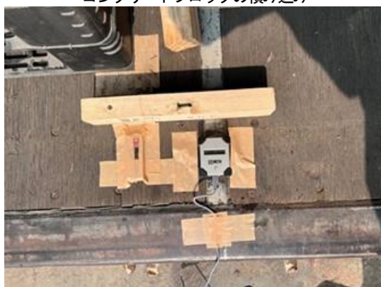
コンテナ内床部に設置したセンサー
