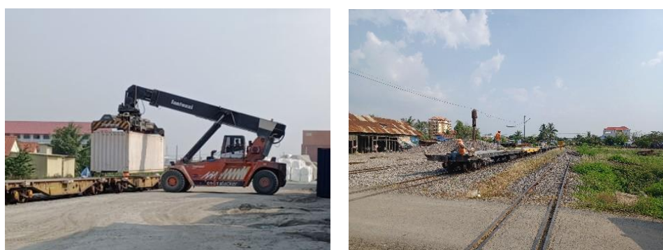
図 3-40 未舗装の荷役ホーム（左図）と踏切を支障する貨車入換（右図）
