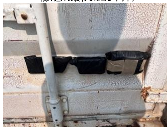
コンテナ外壁面に設置した GPS
