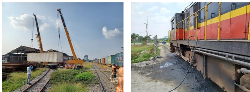
図 3-39 クレーンでの荷役（左図）と本線上で燃料補給中の機関車（右図）
