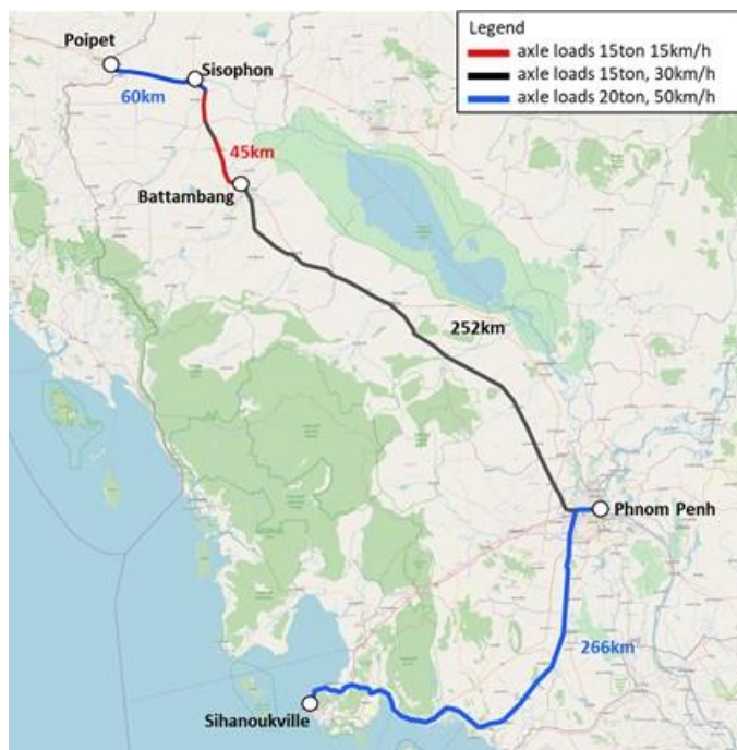
図 3-5 路線の状態（区間ごとの軸重と設計速度）
