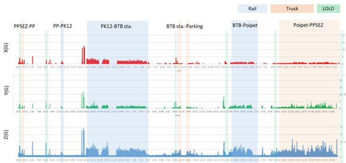
図 3-33 振動計による振動の計測結果
