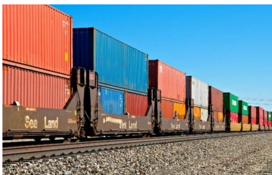
図 3-19 ダブルスタック専用の貨車例
