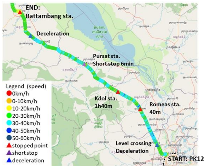
図 3-27 PK12-Battambang 間の速度分布と停車位置
