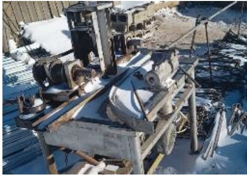
現地のパイプ曲げ機（手作業で曲げる）
