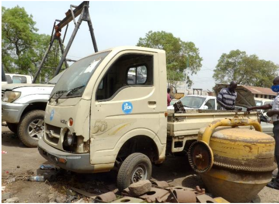
パーツ不足により修理されていない供与機材
