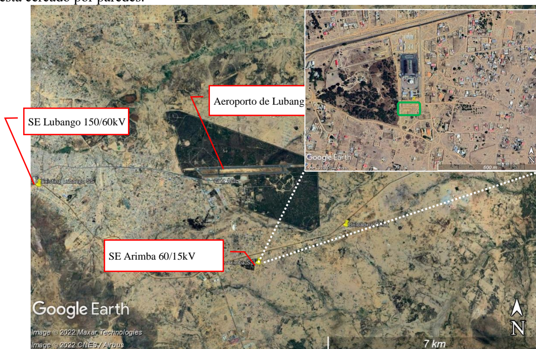
Figura 4.3-1 O local candidato para construção da SE Arimba 60/15kV
