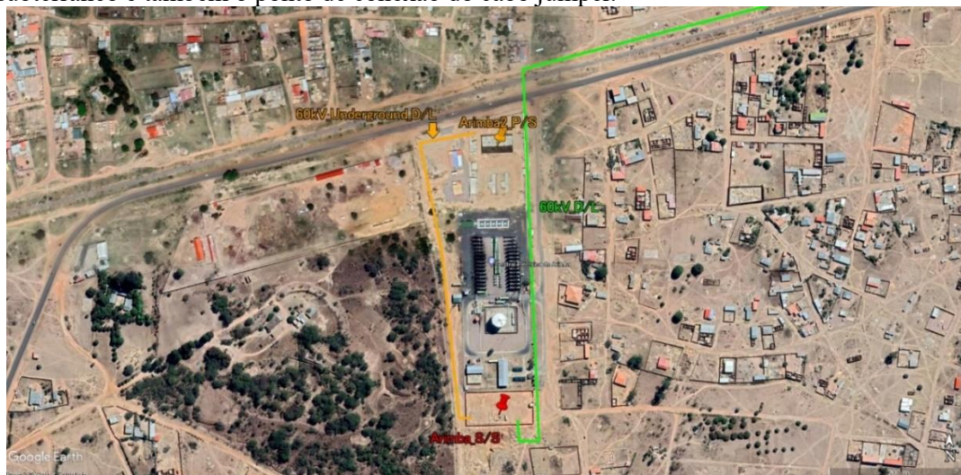
Figura 7.4-1 Rota da LD 60kV subterrânea
