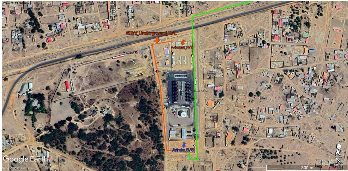
図 7.4-1 60kV 地中配電線のルート図
