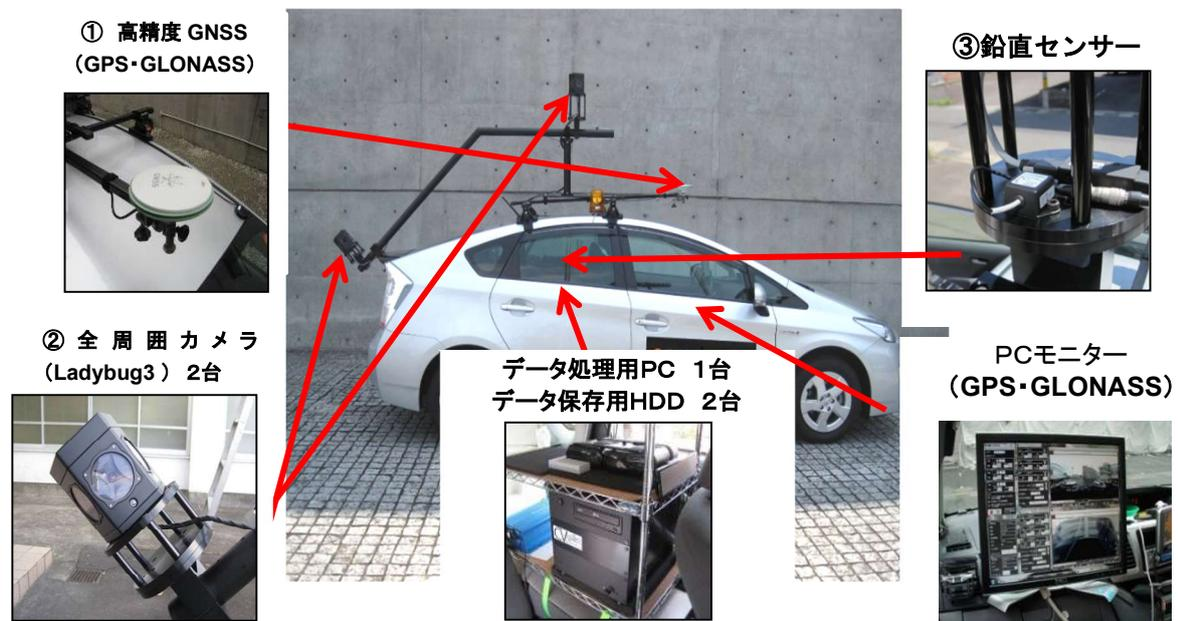
図 2-1 IMS3 の機器と車載例
