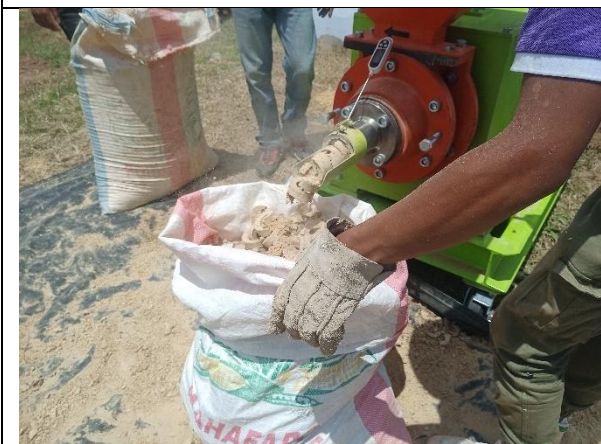
写真 23: グラインドミルの運転デモンストレーションで製造・袋詰めされるカールチップ (アンタナナリボ)
