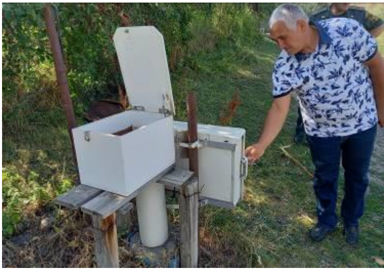
アラビにおいて、本事業で供与した地すべりモニタリング機器の動作状態を確認する MES のエンジニア
