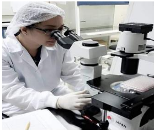
研究所職員による倒立型顕微鏡を用いた細胞変性効果を発見するための 96 ウェル細胞培養用プレートの植菌細胞の観察
