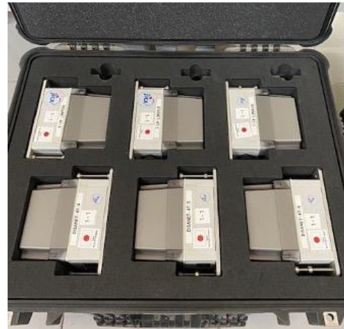
IITH で研究に活用されているポータブル微動観測システム
