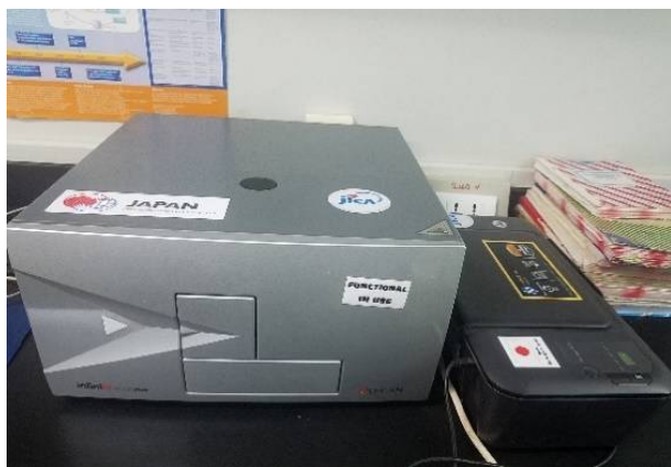
マイクロプレートリーダー (Infinite 200 pro)
