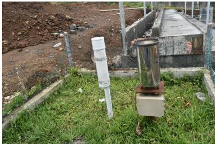
カトルスールの雨量計 MPIによるモニタリング体制の補完として モーリシャス気象局が設置した
