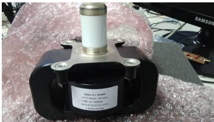
Xバンドドップラーレーダーの修理用に購入された「マグネトロン」
