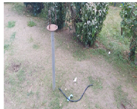
豪雨により損傷を受けた簡易水位計（タンボコ村） (ソロモン諸島)
