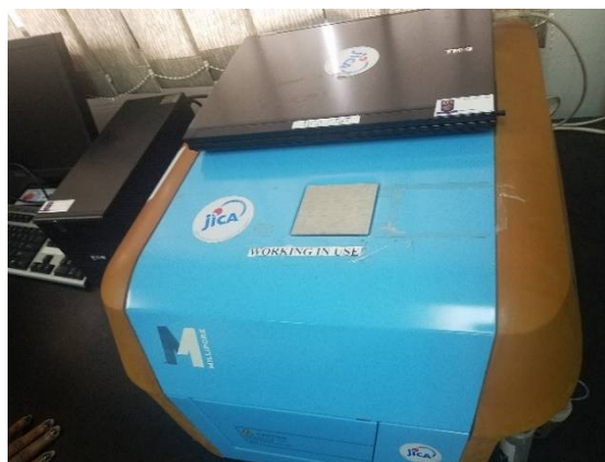
細胞スクリーニング用の自動分析装置 (EasyCyte 5HT)
