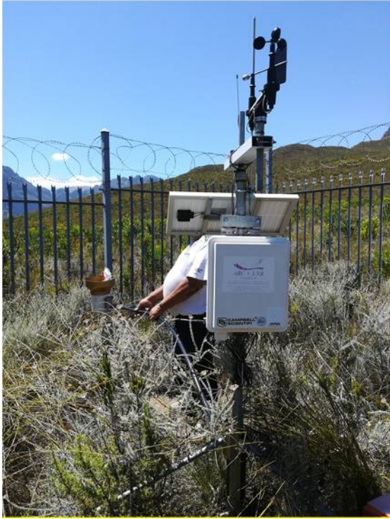
季節変動予測に係る本 SATREPS 事業で調達した 6 カ所の自動気象観測所のうちのひとつ
