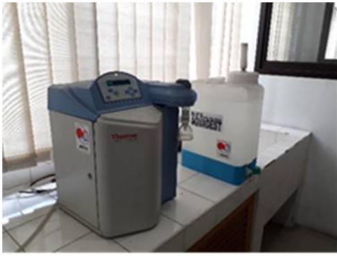
バンドン工科大学火山地質災害軽減センターの研究室に設置された浄水器と Barnstead の超純水造装置 (NANOpureDiamond)
