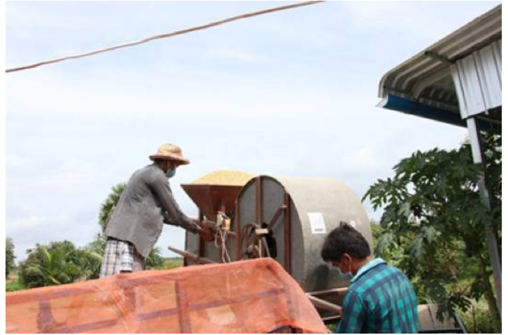
訪問調査時、Muong Ruessei 種子生産グループが籾殻選別機を使用していた。（バタンバン州ムオン・ルセイ郡）
