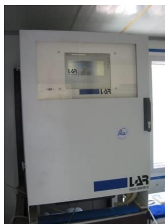
黒河金盆ダム湖の上流域に設置されている毒物センサー。 設置後、現在まで故障は起きていない。
