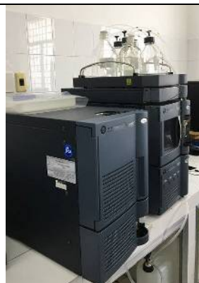
カントー市のNAFIQAD支局6にある超高速液体クロマトグラフィーシステム
