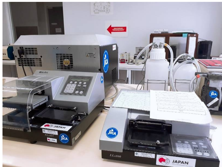
抗原・抗体結合を読み取るイライザ機材 (インドネシア大学)
