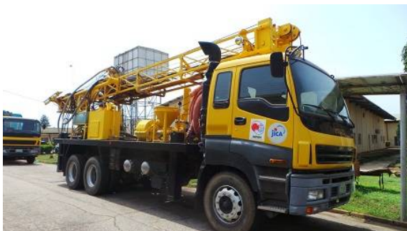
良好な状態のNWRIに贈与された掘削機
